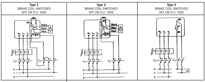
THE MOTOR MUST NEVER BE SWITCHED ON UNLESS THE BRAKE IS ENERGISED AND THE BRAKE SHOULD NEVER BE DE-ENERGISED WHEN THE MOTOR IS ON THE INTERLOCKING OF TWO CONTACTORS IS ABSOLUTELY NECESSARY.
